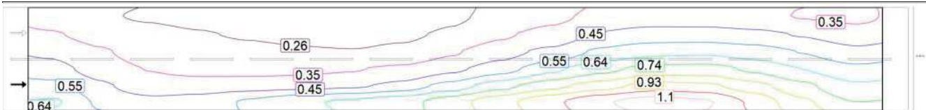
Obserwator 1: Wartości konserwacji, luminacja przy suchej jezdni [cd/m 2 ] (Izoluksy)
